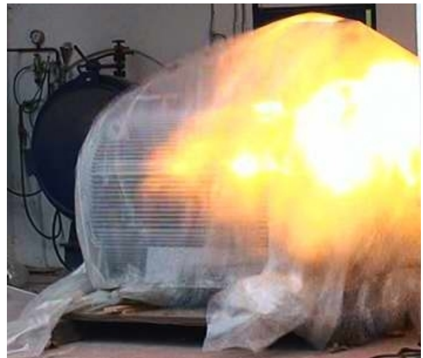
Slika 2 - Trenutak propaljenja 'Ex d' elektromotora prilikom tipnog ispitivanja na probajno paljenje u laboratoriju Ex-Agencije.
